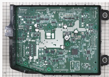
Xiaomi(小米) SU7 Max搭載 統合ECU (BCM LH) 内部
