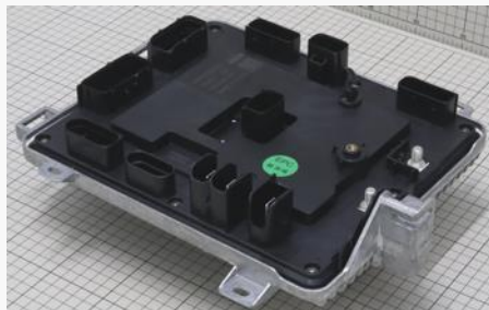
Xiaomi SU7 Max搭載 統合ECU (BCM FRONT) 外観
