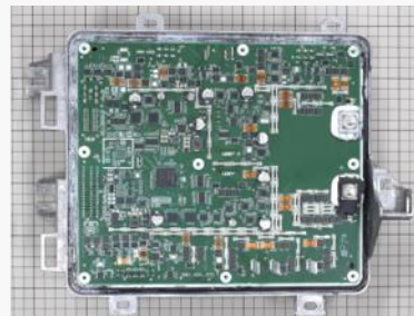
Xiaomi SU7 Max搭載 統合ECU(BCM FRONT) 内部
